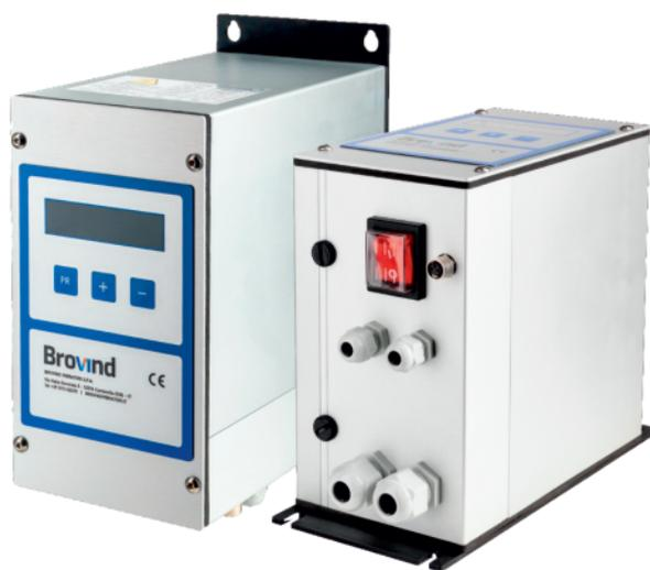
O CFF, utilizado para controlar unidades de accionamento electromagnético, a 3000 ou 6000 oscilações/min. Têm uma gama de tensão de entrada de 110V a 230V, proporcionam um excelente controlo da velocidade do vibrador e mantém-na constante ao longo do tempo através de um sensor de feedback, inclusive na presença de variação da rede elétrica e da carga.
